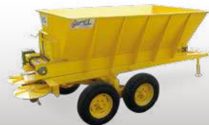
DAOS Tandem aro 16" capacidade 4 t, para 3,3 m 3
