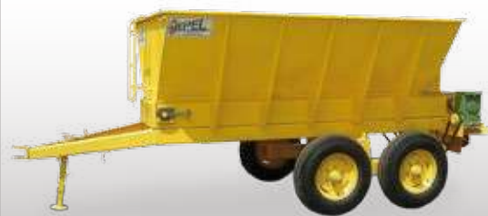
DAOS Tandem aro 16" capacidade 4 t, para 3,3 m 3
