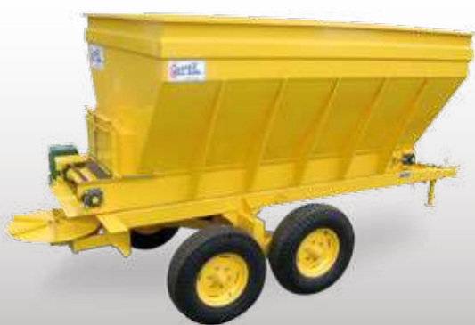
DAOS Tandem aro 16" capacidade 6 t, para 6 m 3 , monodisco
