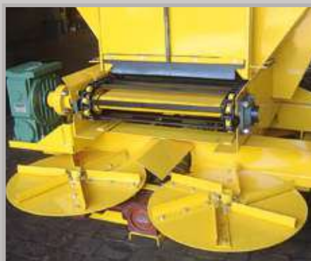
Disco duplo com 630 mm e esteira de 700 mm.
