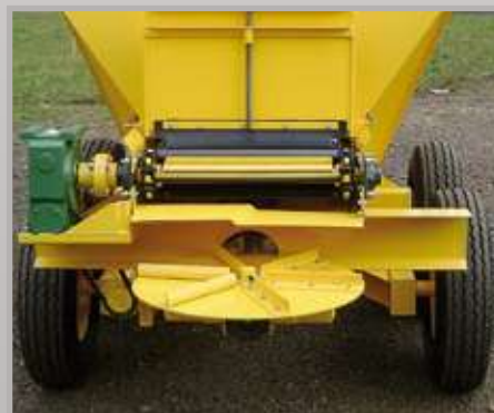
Disco simples de 730 mm e esteira de 700 mm.
