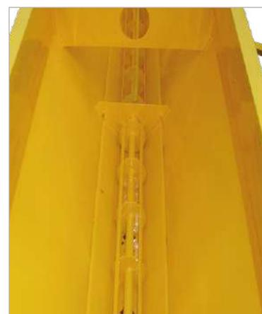
Sistema de distribuição com rotor agitador.
