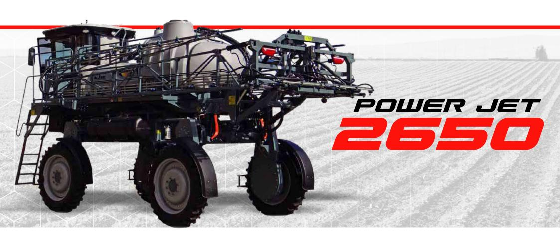
O pulverizador POWER JET 2650 foi projetado para adaptar-se nos mais diferentes terrenos, pois possui um sistema de transmissão mecânica 4x4 e seu sistema de direção é bidirecional, mantendo um só rastro nas curvas.
