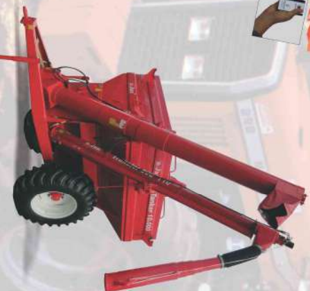
Embreagem Eletromagnética: Accionada por controle remoto para mover o tubo multuso.
