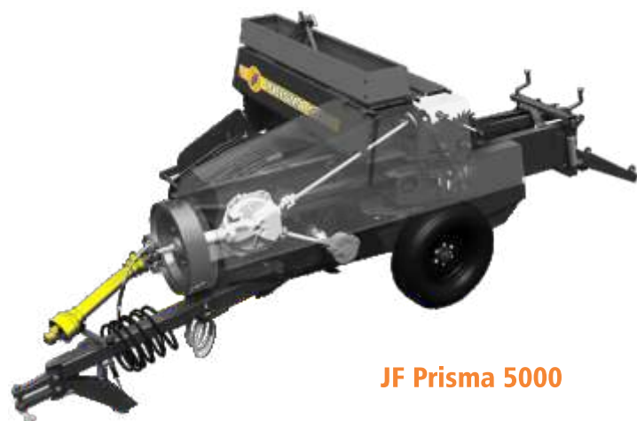
Pistão de alta velocidade 100 golpes/min
