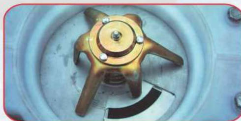
Regulagem fina - para pequenas taxas de aplicação. Bases do sistema de regulagem de fluxo, em nylon injetado.
