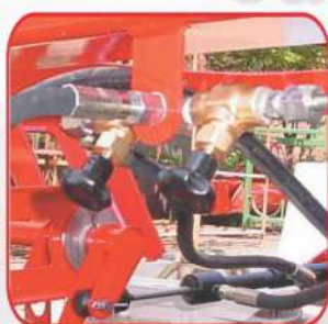
Acionamento hidráulico de dupla ação ou mecânico, através de cabos, do sistema de abertura de saída do produto.
