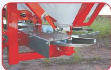
Discos de distribuição, reguladores de fluxo, palhetas e proteção dos discos em material anticorrosivo.
