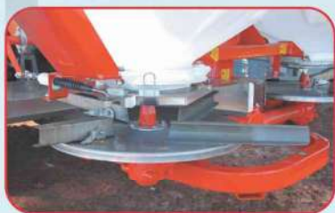
Sistema de largura de distribuição variável, através de troca de palhetas.
